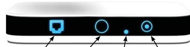
ETHERNET PORT    BLE ANTENNA SOCKET    FACTORY RESET    POWER JACK
